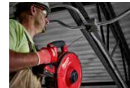
AUTO-RUN™ automatisch aangedreven in- en uitschuiven
