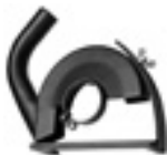
Zuigbeschermpap met geleideslede voor doorslijp- schijven Ø 180 mm, snijdiepte 40 mm, aansluiting Ø 32 mm
