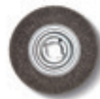
Staalborstel Ø 250 mm x 60 mm, met zeer hoge draadtreksterkte voor uiterst rendabel gebruik, opnameboorgat Ø 51 mm. 0,2 mm draaddikte voor dunwandige buizen en profielen. 0,35 mm draaddikte voor universeel gebruik. 0,5 mm draaddikte voor dikwandige buizen en profielen en hoge afbraamcapaciteit. Stalen uitvoering
